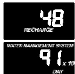
Na dnu zaslona prikazat će se znamenka i natpis DAY (dan). Znamenka će označavati broj dana od puštanja omešivača vode u pogon. Nakon 1999 dana od puštanja u pogon na zaslonu će biti prikazan faktor x10
